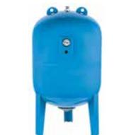
Гидроаккумуляторы UNIPUMP предназначены для поддержания постоянного давления в системе водоснабжения, предотвращения гидравлических ударов, для хранения запаса воды (определяемого объёмом бака), а также для работы в составе автоматических насосных станций. Наличие гидроаккумулятора в системе автономного водоснабжения позволяет снизить количество включений и выключений насоса, что увеличивает срок его службы.
