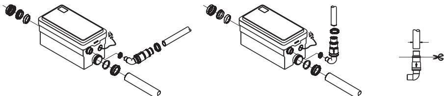
Для присоединения к боковым входам используйте уплотнительные кольца (D) и резьбовые гайки (B). Неиспользуемые входы закройте пробками-заглушками (C). Для присоединения к общей канализации используйте патрубок с обратным клапаном (A), закрепив его хомутами (E). Патрубок (A) должен быть установлен таким образом, чтобы стрелка на его
